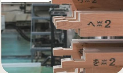
プレカットとは、木造住宅の柱や梁の接合部分（継手や仕口）部分をあらかじめ加工し、建築現場ですぐ使えるようにすることです。大半は機械で加工しますが、機械では難しい箇所は手作業で行います。
