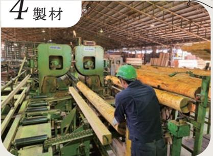
丸太を木材として使いやすい角材や板に加工することを製材といいます。丸太の皮をむいて、製材機に通して切断します。その後、反りや割れで困らないよう、人工乾燥を行って水分を減らし安定させます。
